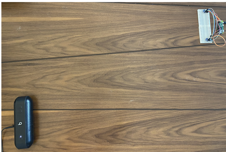
Figura 3.3: Montaje para determinar la respuesta del sistema como función de la frecuencia.
