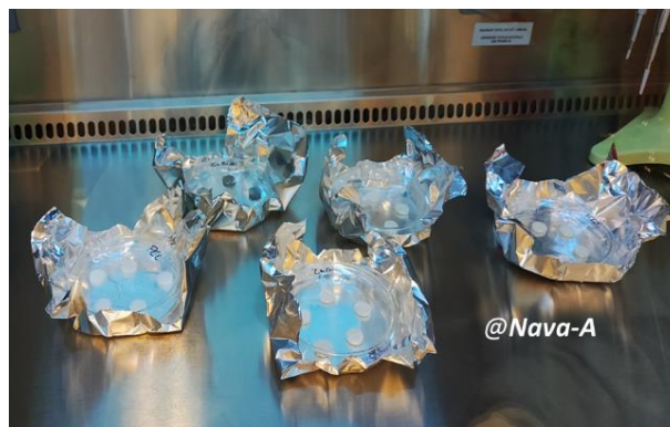
Figura 13. Esterilización mediante Rayos UV en una campana de flujo laminar. Fuente directa.
