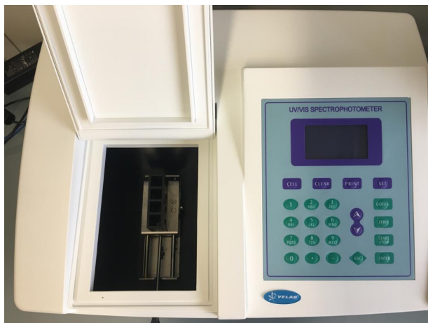
Figura 3.9: Espectrofotómetro UV-Vis VELAB
