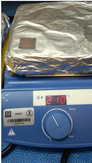
Figura 3.5: Tratamiento térmico para la síntesis de la perovskita
