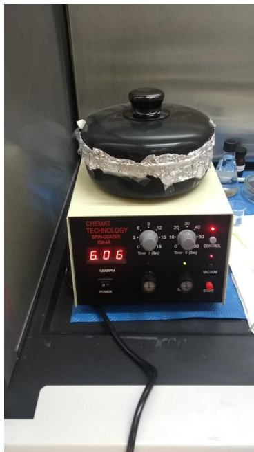
Figura 3.4: Depositación por spin coating
