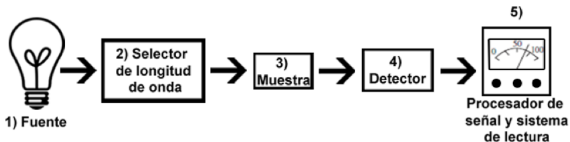
Figura 1.7: Pasos para las mediciones de absorción dentro del espectrofotómetro. Tomado de la tesis Moreno, J., (2018). Energía y determinación de la energía de brecha prohibida de compuestos presentes en mezclas de polvos: sistemas bifásicos. Facultad de Ingeniería Química, Universidad Autónoma de Puebla.
