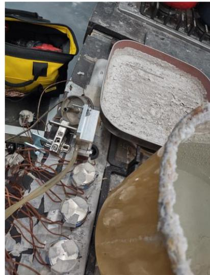
Ilustración 36. Imagen ilustrativa ensayo de radiación y convección térmicas en quemadores a gas.
