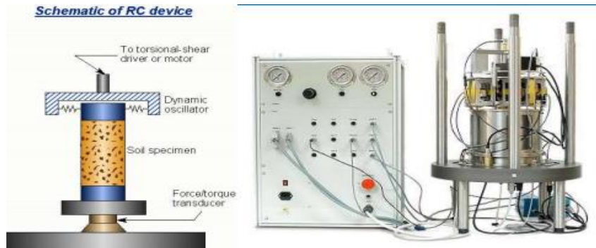
Imagen 4.3-4: Prueba de la columna resonante. (Diaz, 2021)
