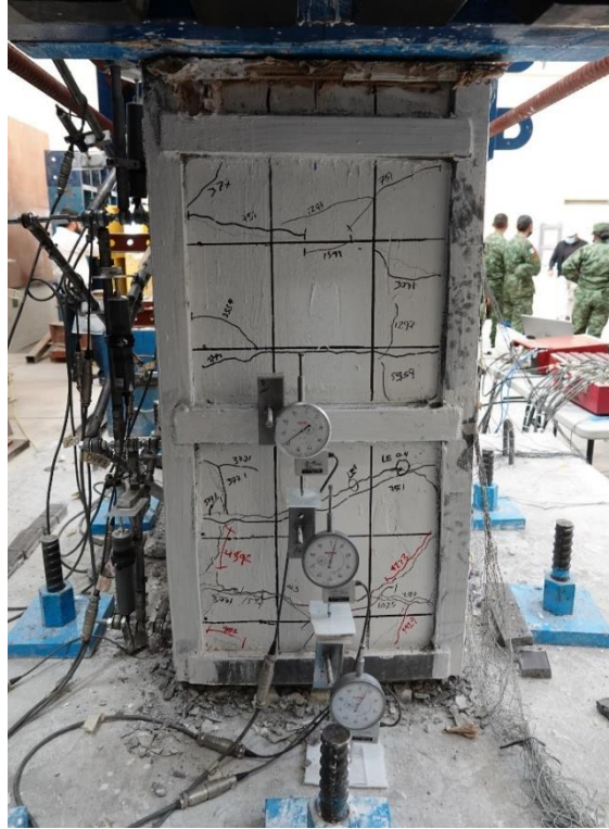
Fig. 3.3.144 Cara este ( R=-4\% ) - Columna C-2 (Instituto de Ingeniería, 2021 - 2023)
