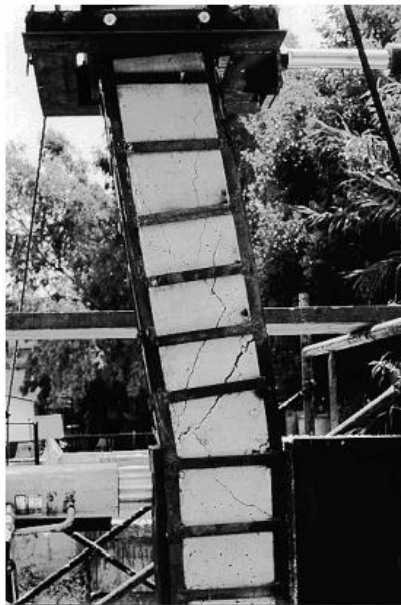
Fig. 1.1.4 Modelo y falla típica (González, 2007)
