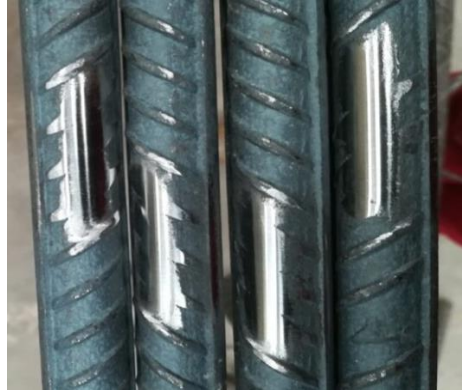
Fig. 2.5.4 Acabado tipo espejo (Alcocer, y otros, 2022)
