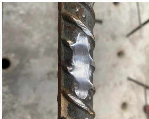
Fig. 2.5.3 Acabado de la barra después del desbaste (Palma, 2022 - 2023)
