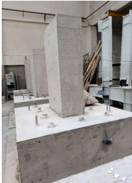
Fig. 2.5.19 Especímenes curados y fraguados (Instituto de Ingeniería, 2021 - 2023)
