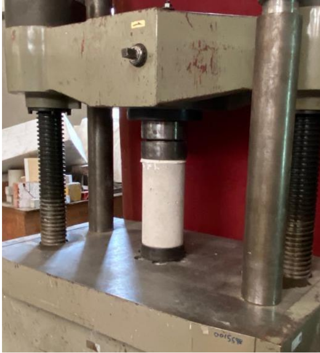
Fig. 2.6.3 Cilindro colocado para ser probado a compresión (Palma, 2022 - 2023)
