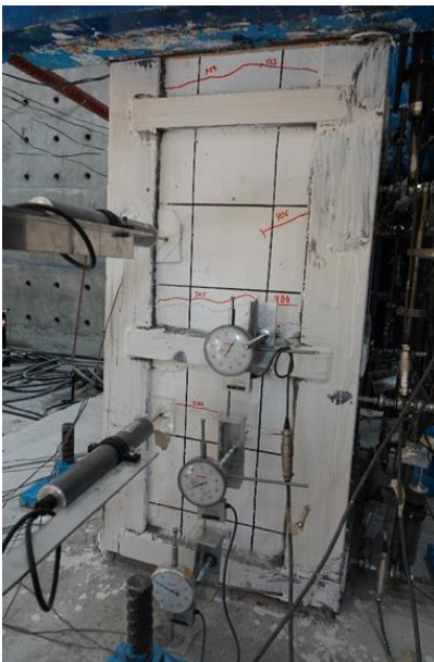
Fig. 3.3.190 Cara oeste ( R=0.5\% ) - Columna C-4 (Instituto de Ingeniería, 2021 - 2023)
