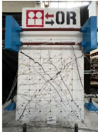
Fig. 3.3.46 Extensión de agrietamiento (R=1%) - Columna OR (Instituto de Ingeniería, 2021 - 2023)
