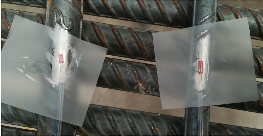
Fig. 2.5.5 Pegado de strain gauge (Instituto de Ingeniería, 2021 - 2023)
