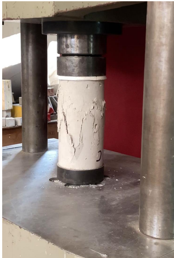
Fig. 2.6.4 Cilindro al final de la prueba de compresión (Palma, 2022 - 2023)
