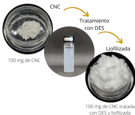
Figura 13.- Proceso de liofilización de la CNC después del tratamiento de funcionalización con DES.
