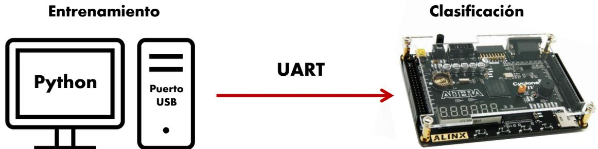
Figura 5.5: Conexión entre la unidad de entrenamiento y la unidad de clasificación
