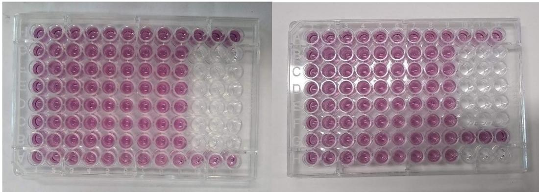
**Figura 9.** Reacción colorimétrica de la reducción del DPPH con la miel de eucalipto (izquierda) y miel de cítricos y azahar (derecha).
