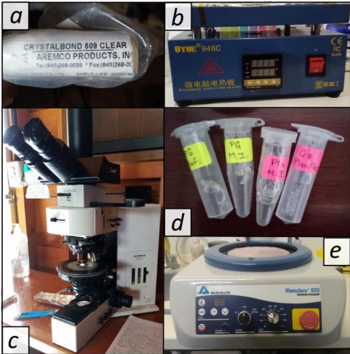
Fig. 4.4. a) Barra de crystalbond para montar cristales y llevar las BFu al plano horizontal. b) Plancha térmica utilizada para calentar crystalbond y poder manipular los cristales encapsulados. c) Microscopio petrográfico que se utilizó en el proceso de montaje y descripción de las IFu y BFu. d) Cristales seleccionados para el estudio. e) Pulidora BUEHLER utilizada para pulir las muestras.
