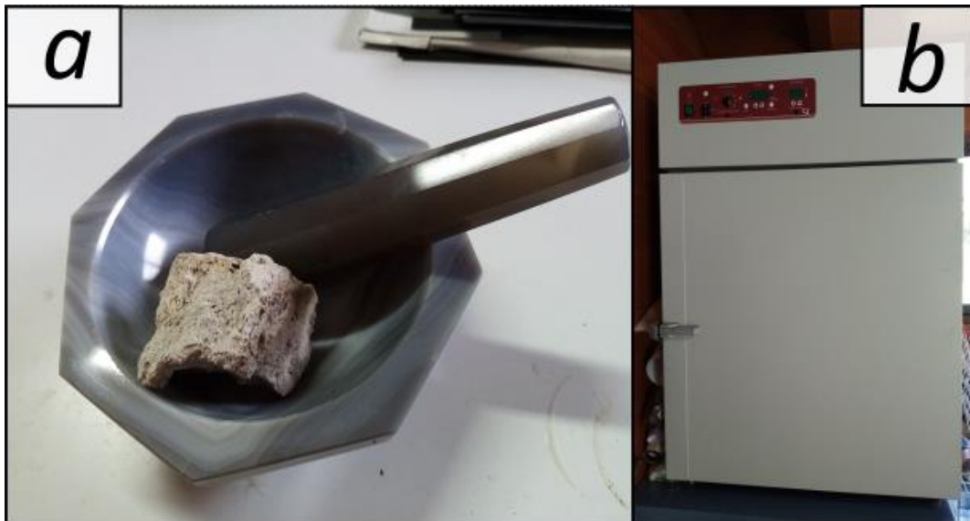
Fig. 4.1. a) Mortero para triturar pómez. b) Horno utilizado para el secado de las muestras después del proceso de decantación.
