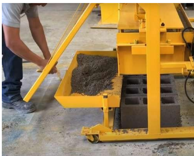
Fig. 12. Usuarios operando maquinaria de Vibro compactación. Fuente: YouTube.
