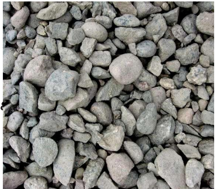
fig. 25 . Ejemplo de agregados para mezcla de concreto. Fuente: Argos 360°
