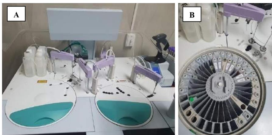
**Figura 29. Compartimiento para Reactivos; A) cerrado. B) abierto.**
