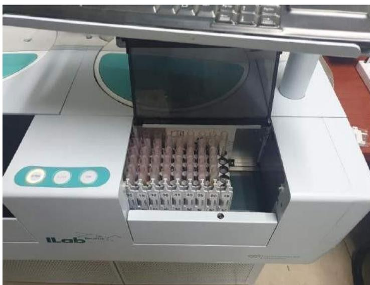
**Figura 31. Muestras introducidas en el analizador ILab Taurus™**
