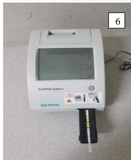
**Figura 11. Analizador CLINITEK Status® +, procesando Control de rutina positivo y negativo Check-Stix®**
