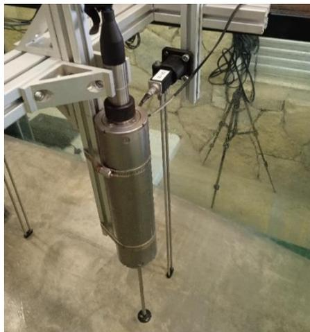
Figura 18. Velocímetro electromagnético Valeport.
