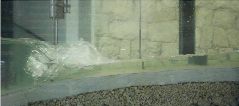
Figura 23. Intermedio de rotura en S7. Caso e2.
