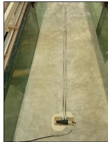
Figura 14. Sensor de Runup
