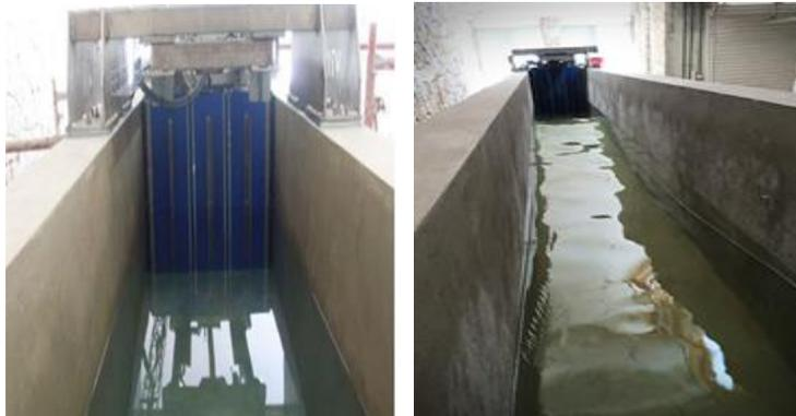
Figura 9. Sistema de generación de oleaje en el canal.
