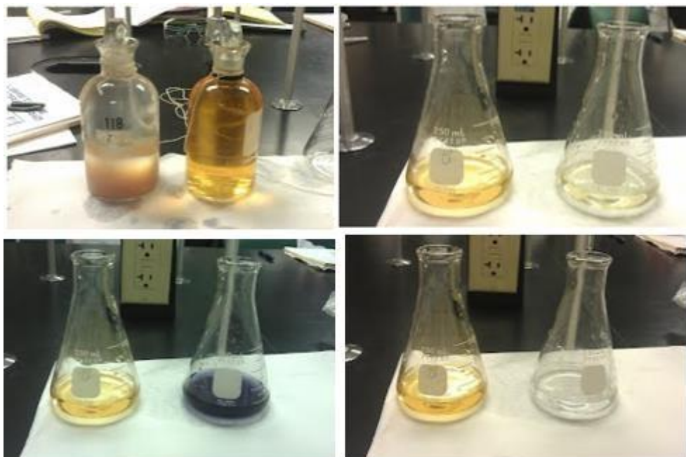
Figura 19. Secuencia experimental para determinación de DBO_5 Tomado de (Sites Google, 2012).
