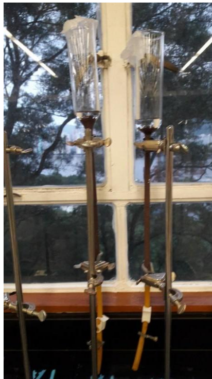
Figura 25. Columna para reducción de nitratos Tomado de (Wikimedia Commons, 2017).
