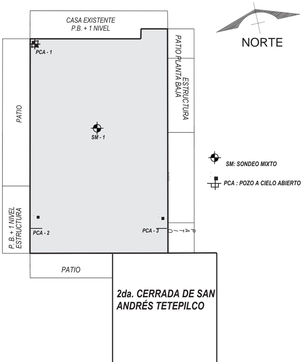
LOCALIZACIÓN DEL SONDEO, POZOS A CIELO ABIERTO Y COLINDANCIAS DEL PREDIO
