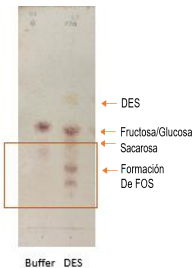
Figura. 18: TLC de la reacción en sistema buffer y DES de izquierda a derecha. Condiciones 10% de sacarosa, 30 min a 50°C.
