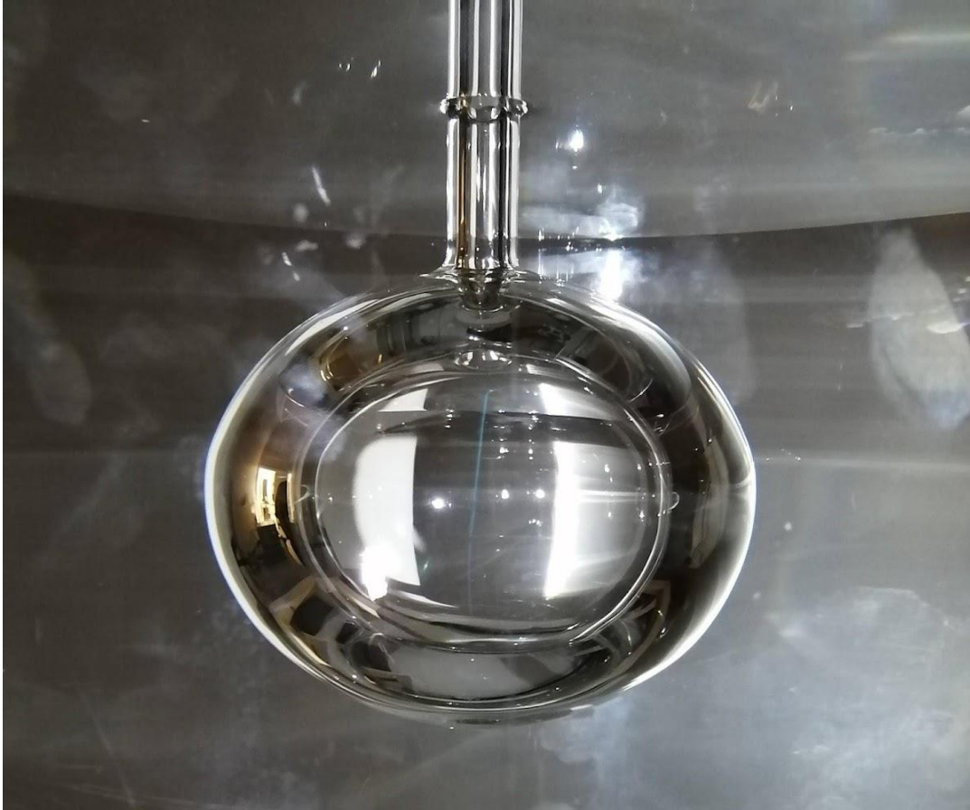
Fig. 24: esfera de cristal sumergida en la pecera para generar ondulaciones en el glicerol. Con permiso de l'École polytechnique, Saclay, París.
