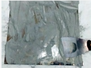
La placa de metal se cubre con esmalte en polvo.
