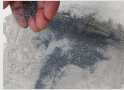
Aplicando carborundum sobre el esmalte en polvo I.
