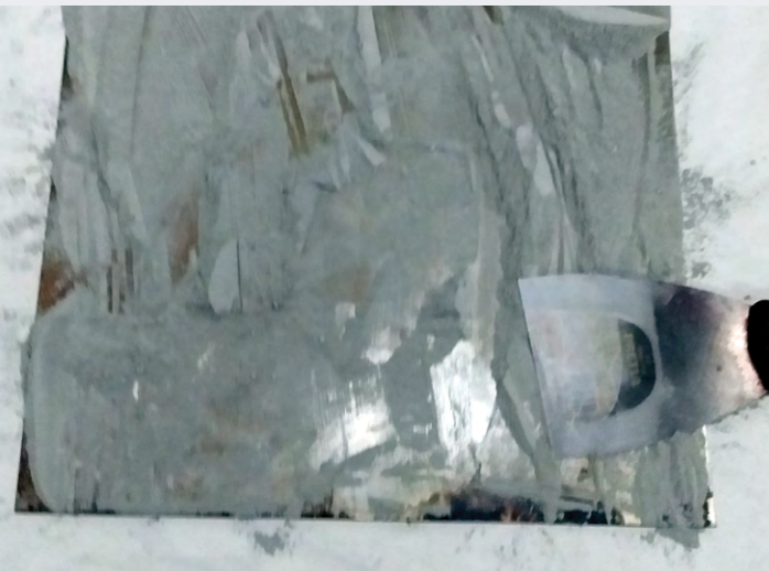
Esmalte epóxico en polvo sobre plancha de hierro.
