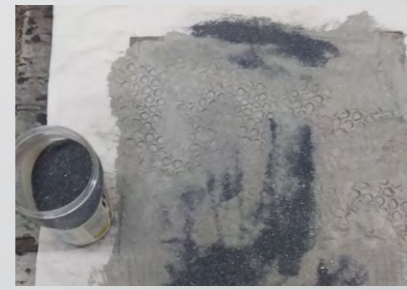
Carborundum sobre el esmalte en polvo.
