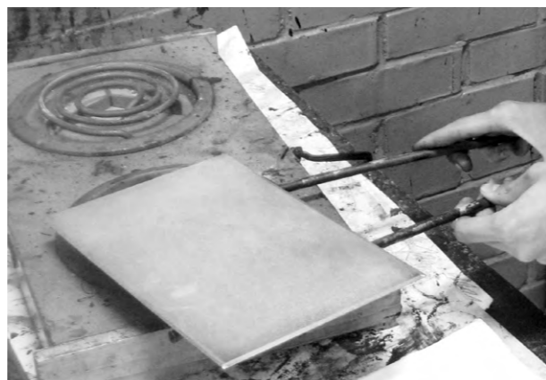
Esmalte de baja temperatura se calienta sobre la parrilla eléctrica.
