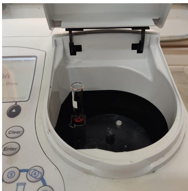
Figura 14. Medición utilizando el espectrofotómetro UV-Vis GENESYS™ 10S UV-Visible Spectrophotometers, Thermo Scientific. Elaboración propia.
