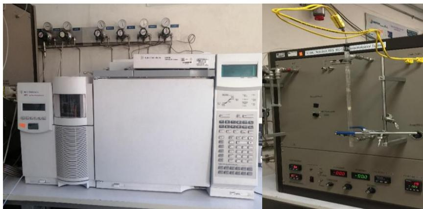
Figura 3.2 Cromatógrafo de gases y equipo de microreacción in situ *Research RIG-150* para las reacciones de oxidación
