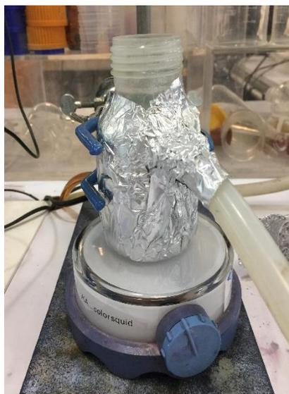
Figura 3.1. Reactor Bach para la síntesis de los catalizadores por el método DPU.
