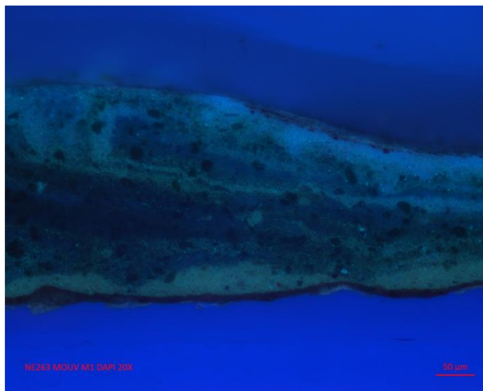
Microscopía ultravioleta, filtro DAPI 430-465 nm, 20X
