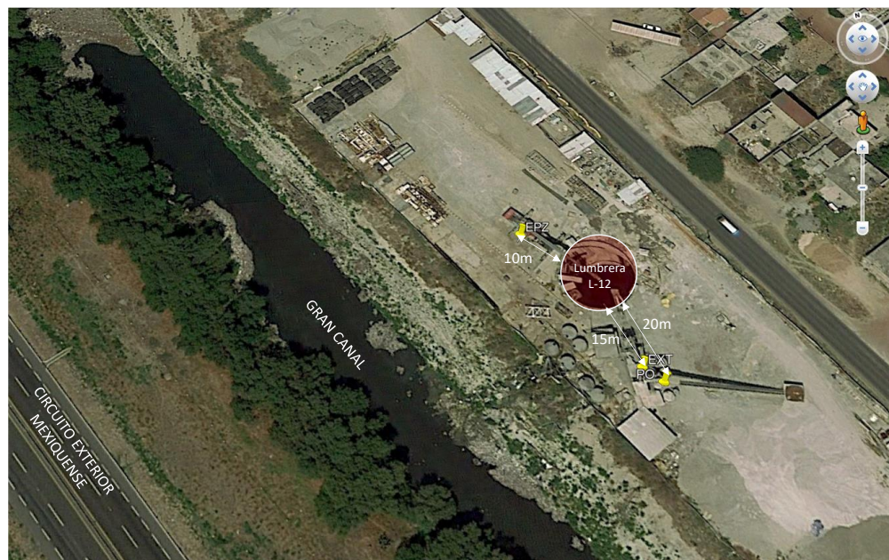
Figura 13.- Ubicación de la instrumentación de la Ingeniería Básica en la lumbrera L-12 (Fuente: CFE, 2008).
