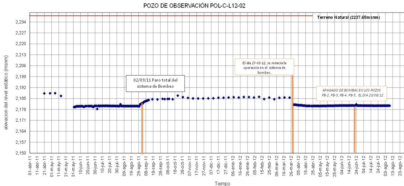
Figura 82.- Monitoreo del pozo de observación POL-L12-02 instalado en la lumbrera L-12. (Fuente: CONAGUA- COMISSA, 2012 readecuado por S. González 2023).
