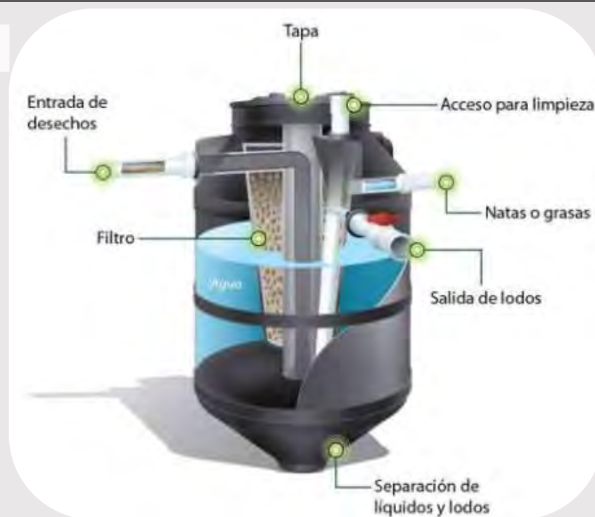
Imagen 224, Características de un Biodigestor, Imagen tomada del sitio web Tecno tanques.
