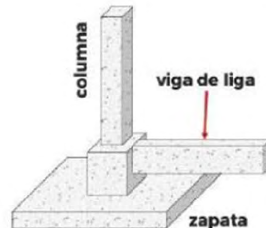
Imagen 204, Ejemplo de una trabe de liga o viga de liga. Imagen tomada de la página web Keobra .com
