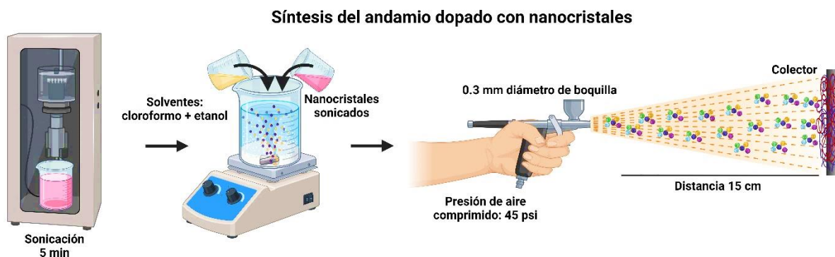
Figura 12. Diagrama de flujo del método de síntesis de los andamios fibrilares de PLA por el método air-jet spraying (AJS). Se muestra el procedimiento paso por paso de la técnica AJS conjugada con NCs. Elaboración propia con la aplicación BioRender.
