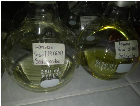
Figura 16. Sobrenadante recuperado de las muestras de sedimento.
