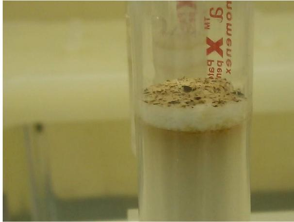
Figura 12. Cartucho con muestra de agua seco
