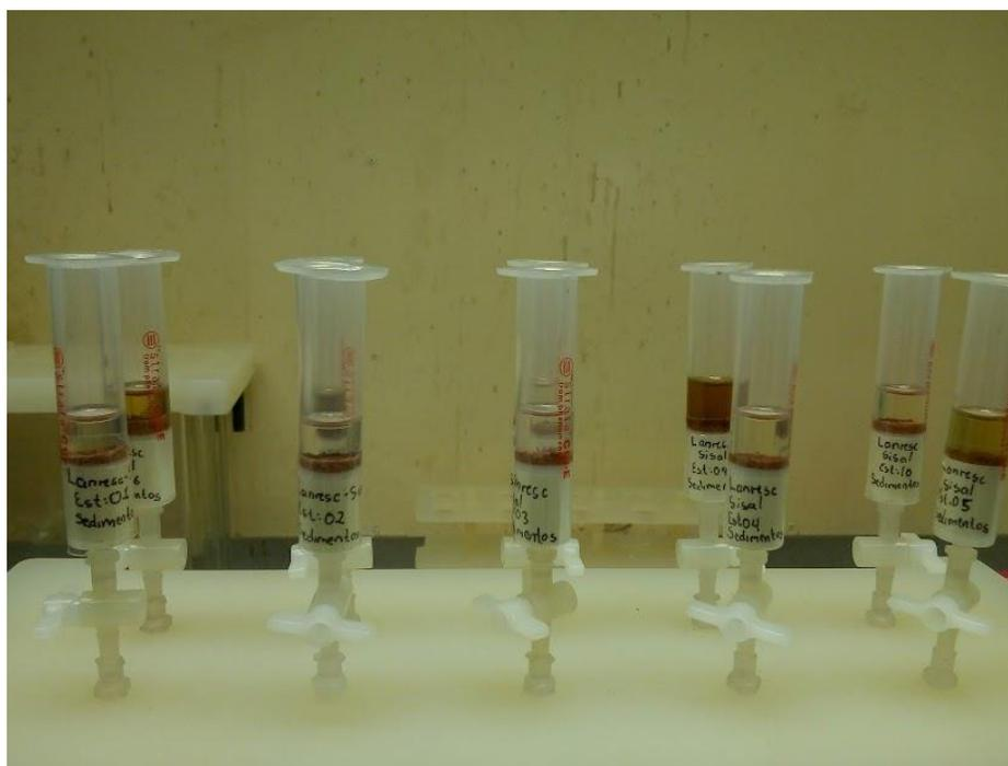
Figura 17. Cartuchos para realizar la extracción en fase sólida de los sedimentos con la capa de cobre para eliminar sulfuros.
