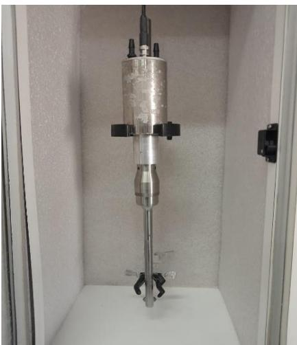
Figura 15. Sonda para la extracción asistida por ultrasonido (USE).
