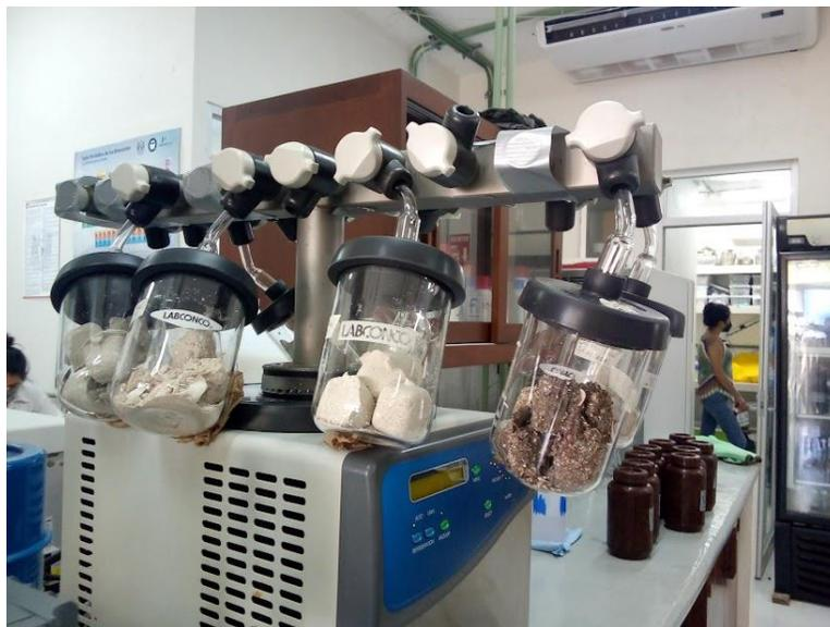
Figura 13. Muestras de sedimento en la liofilizadora.
