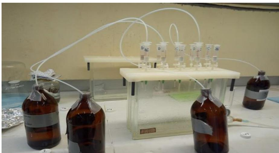
Figura 11. Procedimiento de extracción en fase sólida (EFS) para extraer los plaguicidas de las muestras de agua.
