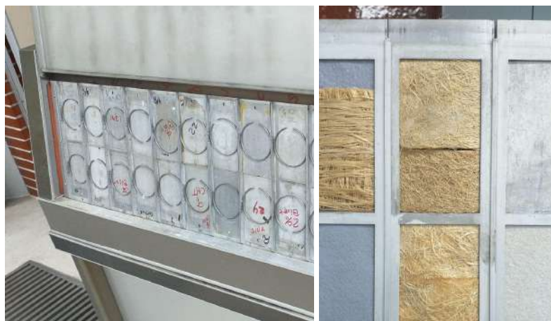
Fig. 66. Muestras de aglomerado después de un mes de radiación UV. Elaboración propia.
