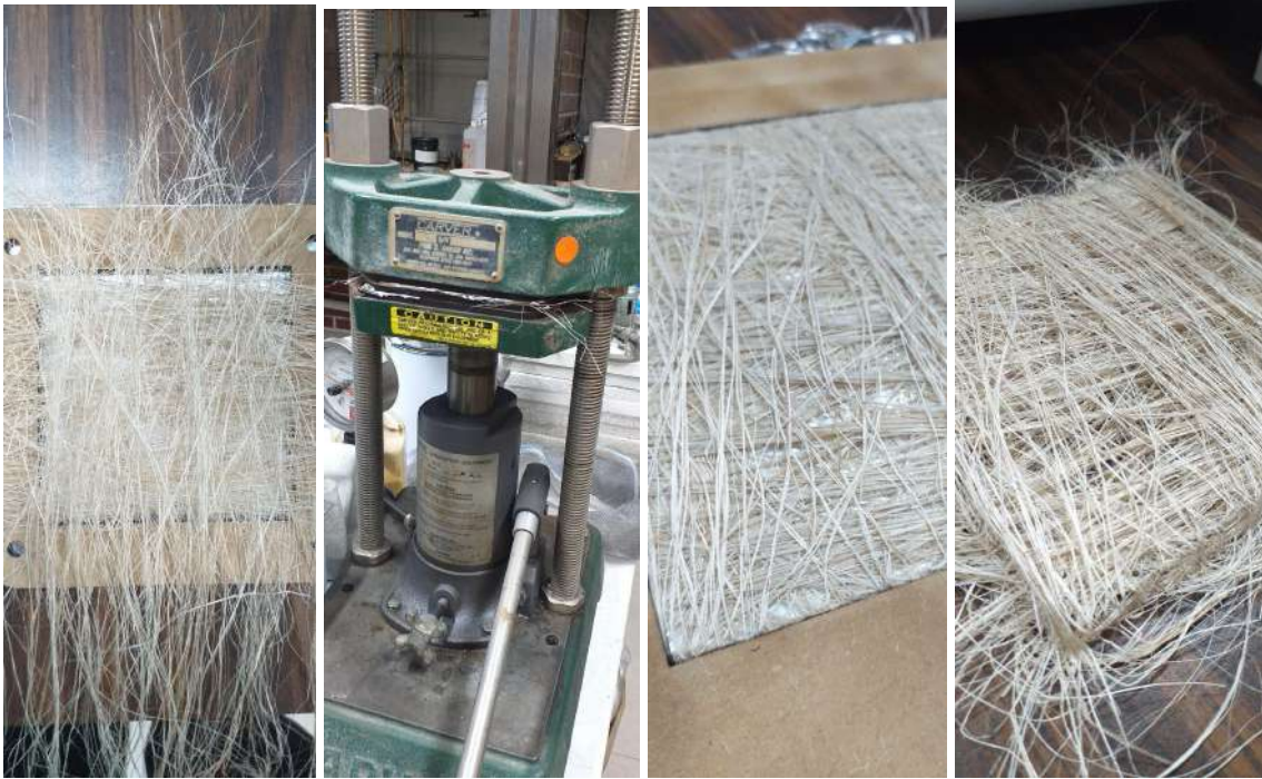
Fig. 36. Prensado de fibras de plátano en doble dirección. Elaboración propia
