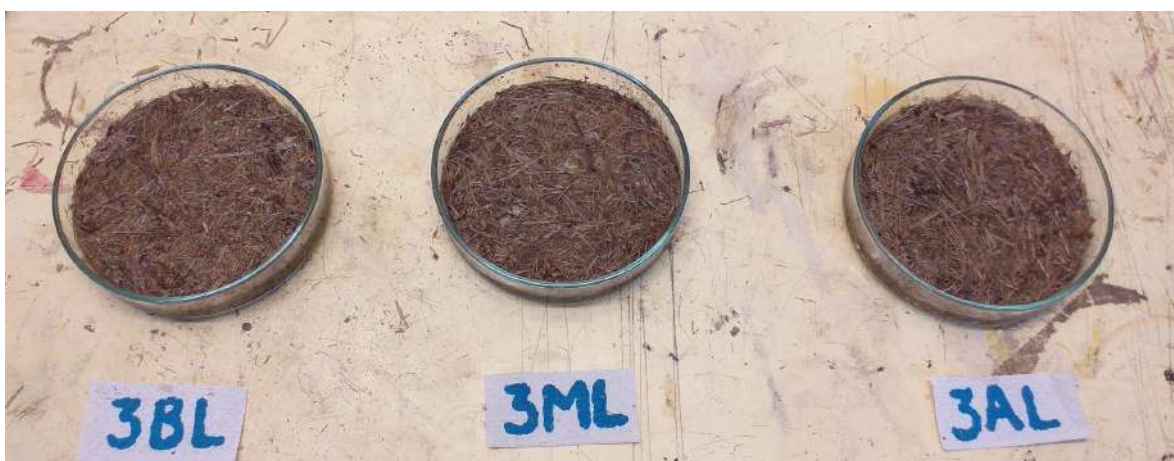
Fig. 50. Mezcla con el 30% de lixiviado con fibras trituradas. Elaboración propia.
