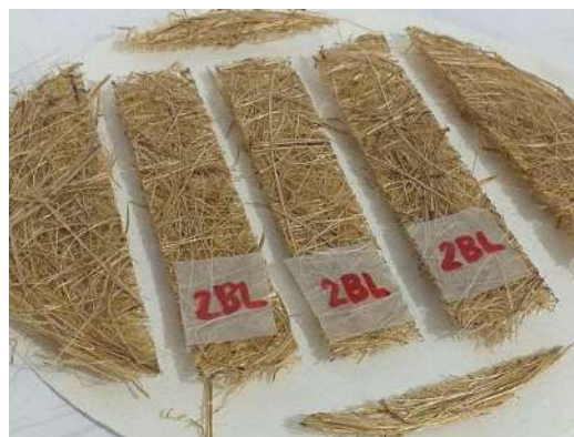
Fig. 52. Muestras adecuadas para pruebas mecánicas. Elaboración propia.
