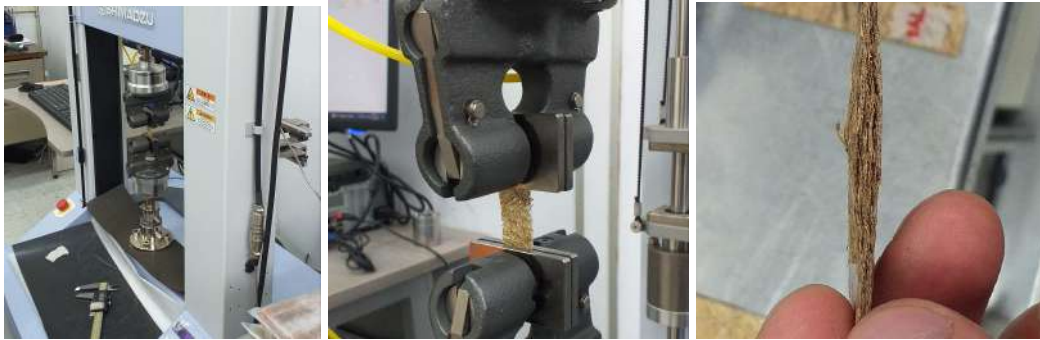
Fig. 56. Pruebas mecánicas a las muestras con fuerza de tracción unidireccional. Elaboración propia
