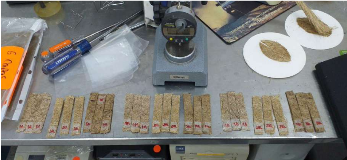
Fig. 53. Toma de grosores de las muestras con un micrómetro digital. Elaboración propia.
