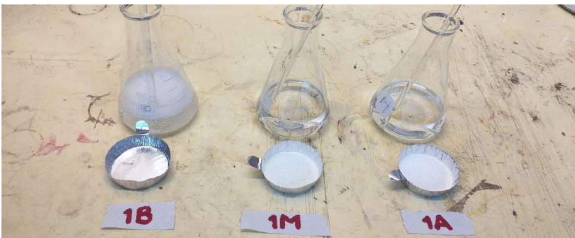
Fig. 44. Mezcla de PVA con agua al 5%. Elaboración propia.
