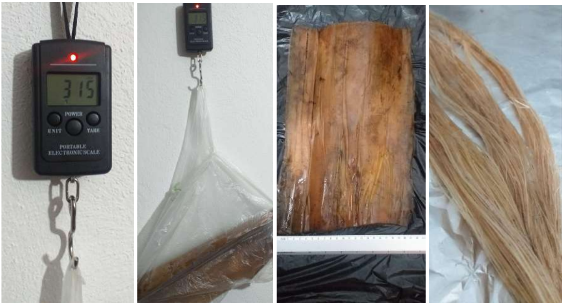
Fig. 41. Pesaje muestra de Pseudotallo y extracción de fibras. Elaboración propia
