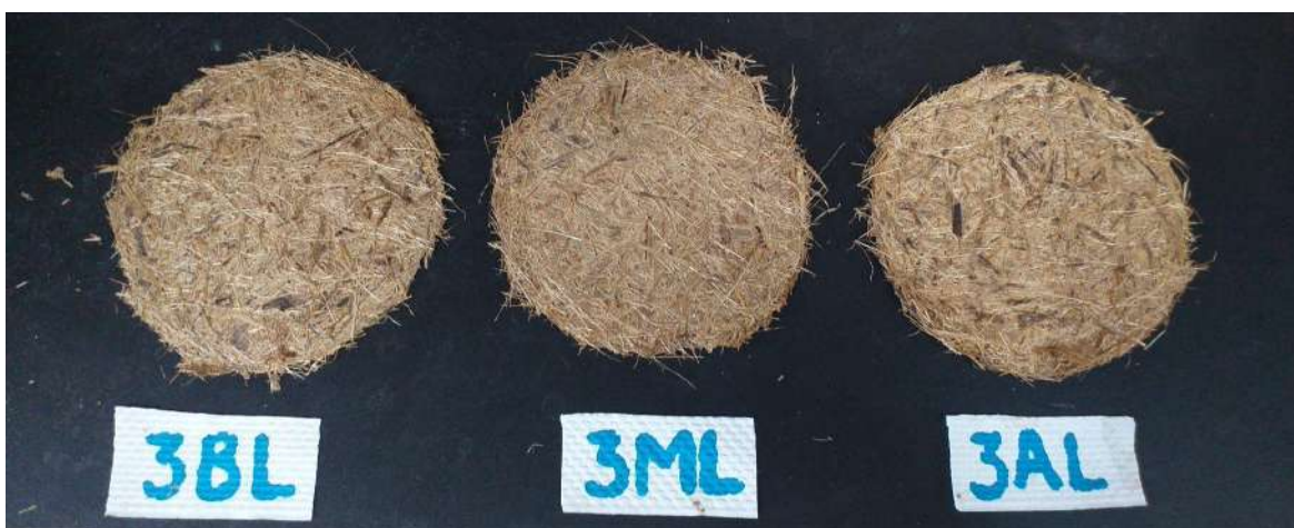
Fig. 51. Muestras de fibras trituradas, prensadas y secas. Elaboración propia
