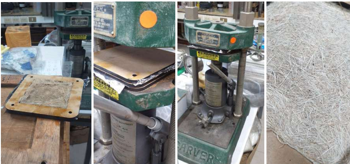
Fig. 38. Prensado de las fibras en dirección aleatoria. Laboratorio del IIM-UNAM. Fotografías propias
