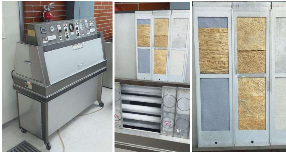
Fig. 65. Muestras de aglomerado en el equipo de envejecimiento acelerado. Laboratorio del IIM-UNAM. Fotografía propia.
