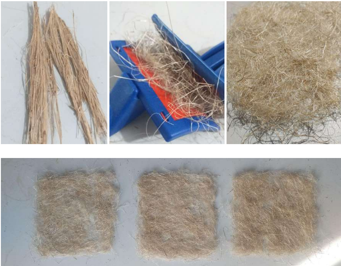
Fig. 37. Cardado de las fibras en dirección aleatoria. Elaboración propia
