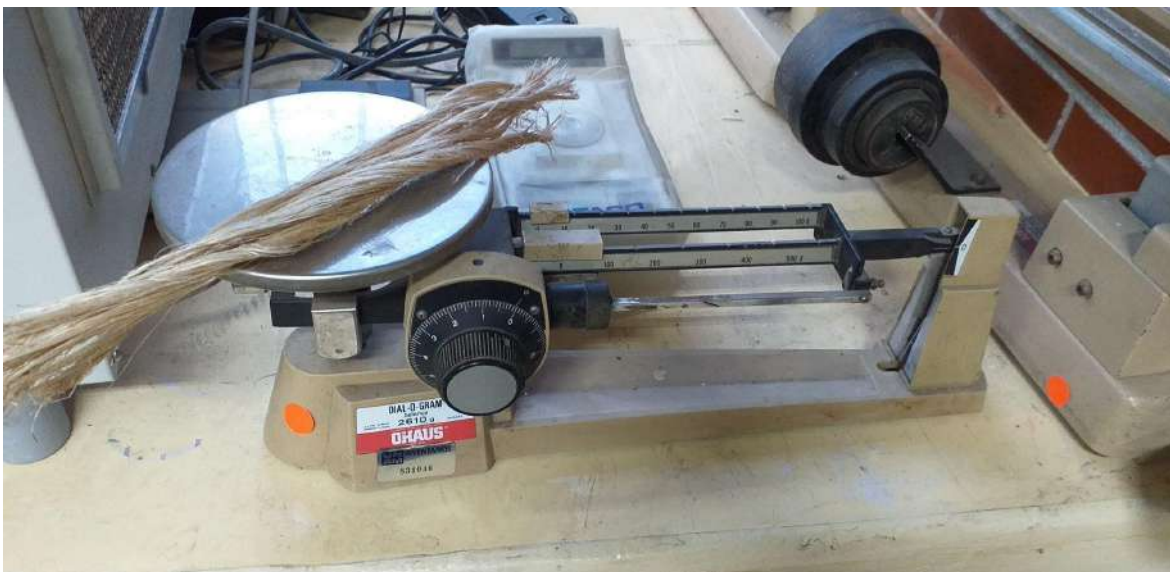
Fig. 42. Pesaje de fibras de plátano secas. Elaboración propia
