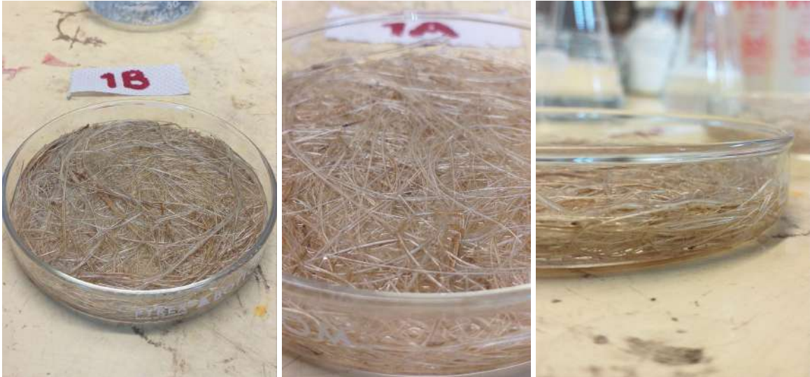
Fig. 45. Mezcla de PVA con fibras de plátano. Elaboración propia.
