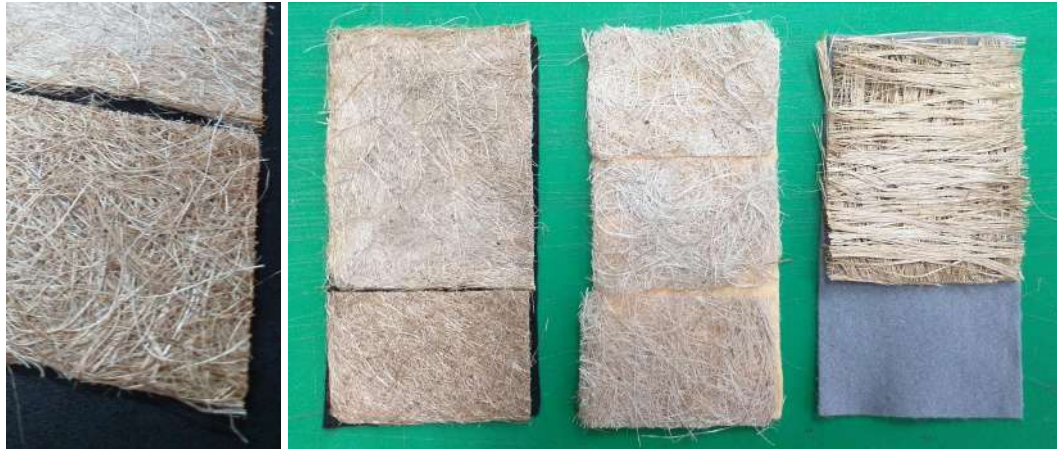
Fig. 64. Muestras de aglomerado para pruebas de radiación UV. Elaboración propia.
