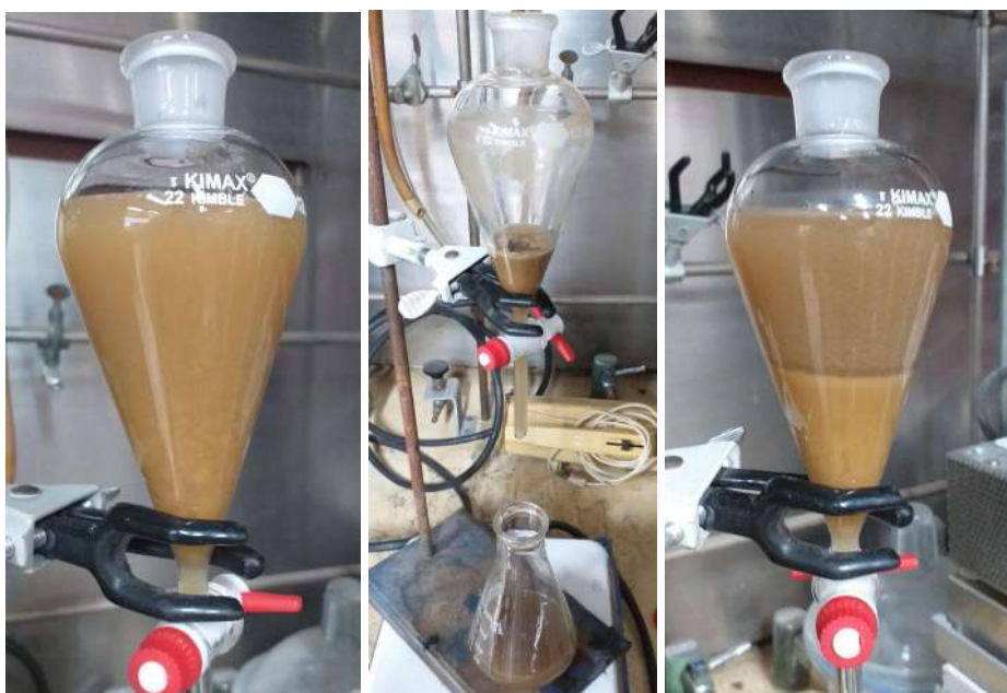
Fig. 47. Sedimentación del lixiviado. Elaboración propia
