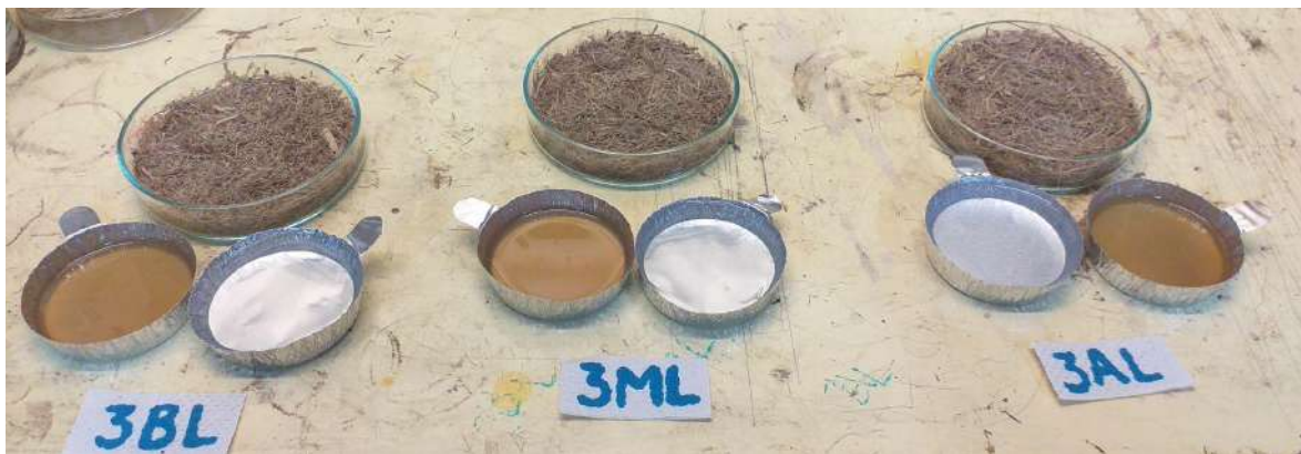
Fig. 50. Mezcla con el 30% de lixiviado con fibras trituradas. Elaboración propia.
