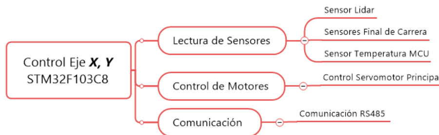
Figura 13: Diagrama de comunicaciones STM32F103C8
