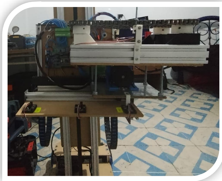
Figura 32: Mecanismo telescópico totalmente extendido
