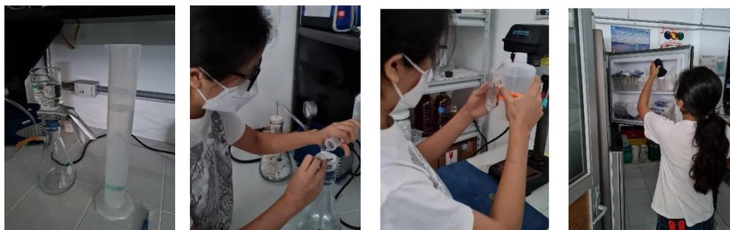
Figura A.5.1. a) Sistema de filtrado montado, b) Retiro de filtro con pinzas, c) Preparación de la muestra para ser triturada. d) Almacenamiento de la muestra antes de su lectura.
