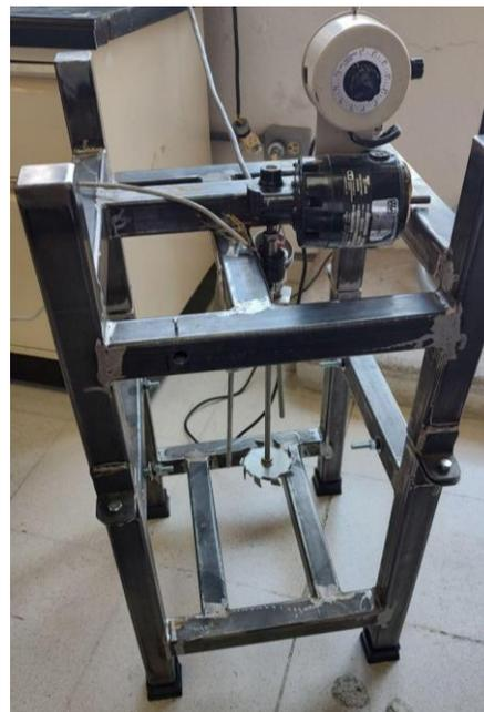
Figura 4.4. Fotografía de la estructura de soporte terminada con los instrumentos de medición y el agitador montados.
