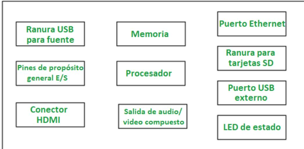
Figura 2.2. Diagrama de bloques de una SBC. Editado de [34].
