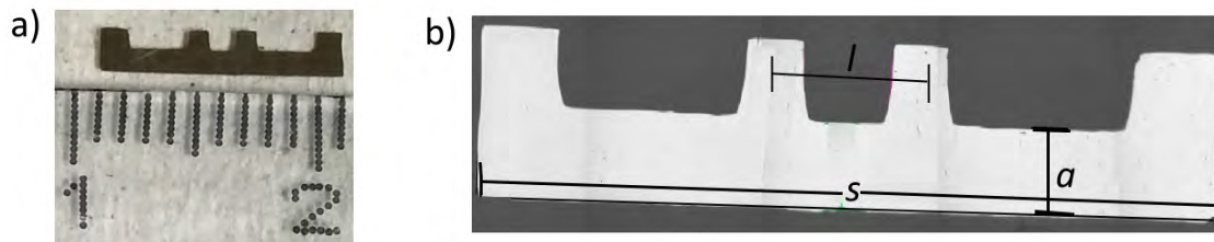
Figura 3.9: a) Película de Al evaporada sobre sustrato de vidrio, usando la mascarilla para mediciones eléctricas. b) Esquema de la cintilla donde se muestran sus parámetros geométricos.
