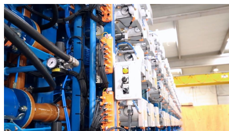
(b) Implementación de maestro IO-link de IFM
