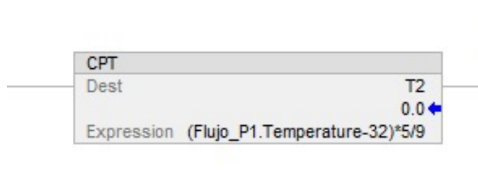
Figura 4.7 Acondicionamiento del sensor SA6010 para despliegue de datos en °C.
