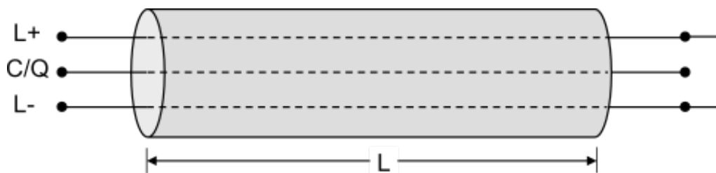
Figura 2.6 Esquemático de cableado IO-Link 7 .
