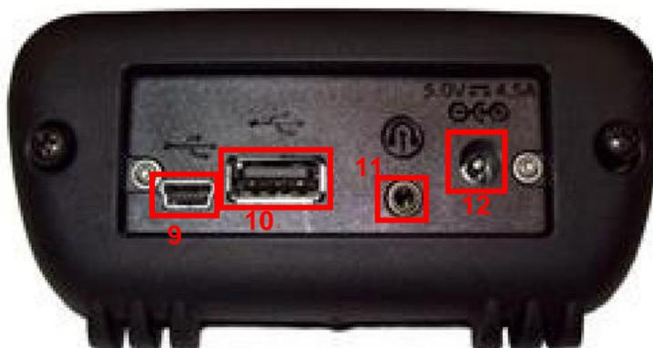
Figura 38: Entradas del GPS Trimble Nomad 1050. Manual del GPS, SIAP.
