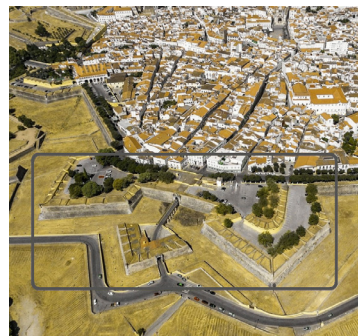
FIG. 26. Ilustración de una fortificación baluartada con tenazas y revellín al centro, acompañado en esta ocasión de un foso. La tenaza es la cara de la plaza compuesta de una cortina y de dos medios baluartes. El ángulo de la tenaza es el que se forma por la intersección de las líneas que se formarían de las dos caras de los baluartes si se prolongasen.
