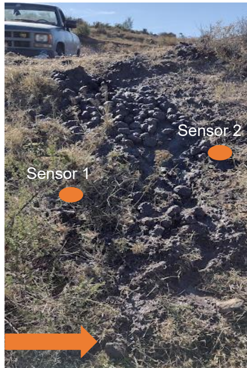
Figura 5.3: Se muestra el depósito del material una vez que el movimiento de la masa se detuvo. Los óvalos naranjas, muestran los puntos en que se encontraban los sensores. La flecha, señala la distancia máxima alcanzada por el material.
