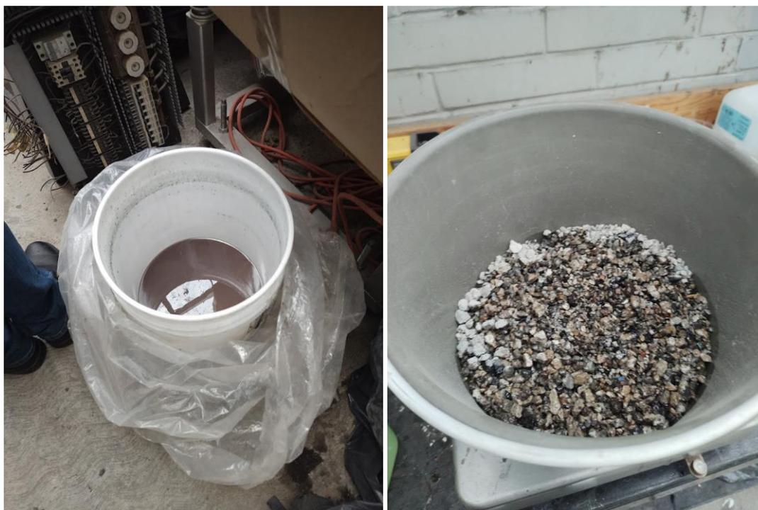
Nota: Se muestra el color de la resina con la que se trabajó y se incorpora a los agregados en estado seco. Fuente: Elaboración propia Dalia Cruz (2022).
