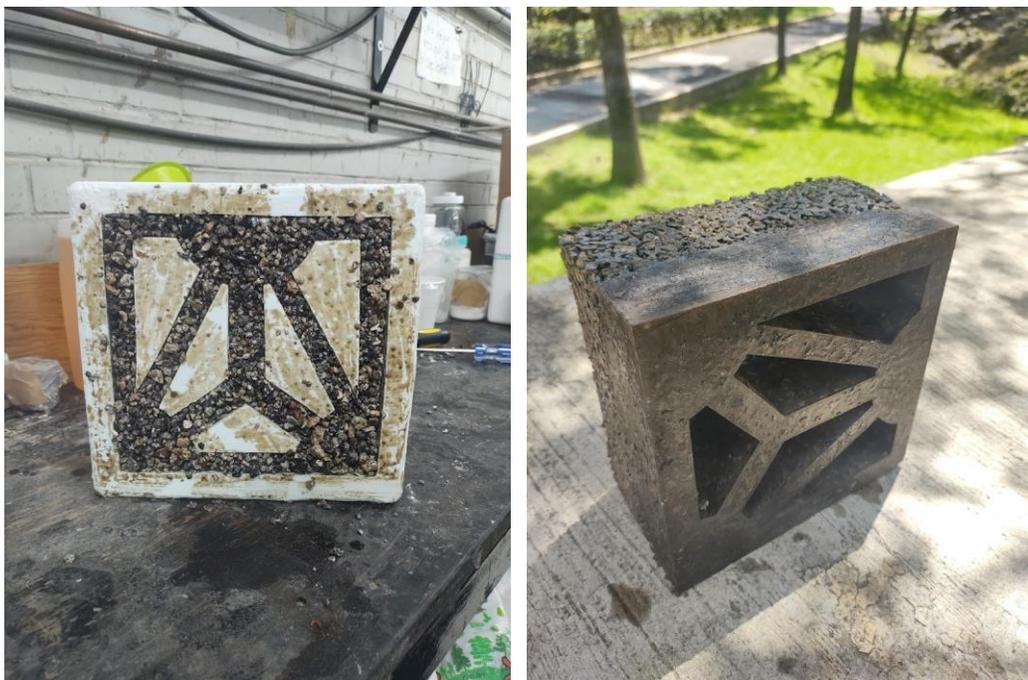
Nota. Se muestran los dos tipos de acabados que se pueden lograr con el concreto polimérico reciclado. Fuente: Elaboración propia Dalia Cruz (2022).
