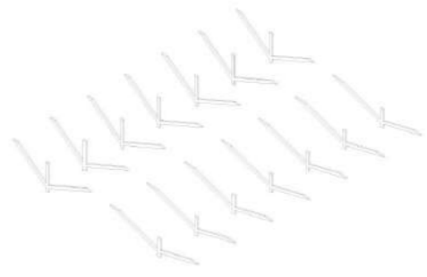
01. Armadura de madera estructural de pino de 16cm x 8cm.
