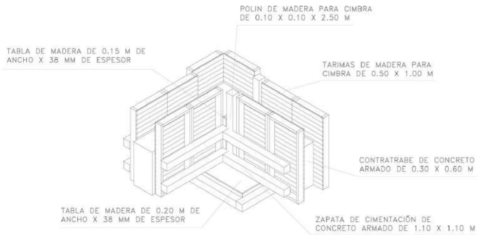
3 DETALLE ISOMETRICO CIMBRA DE ZAPATA REF: D-1 ESCALA 1:20
