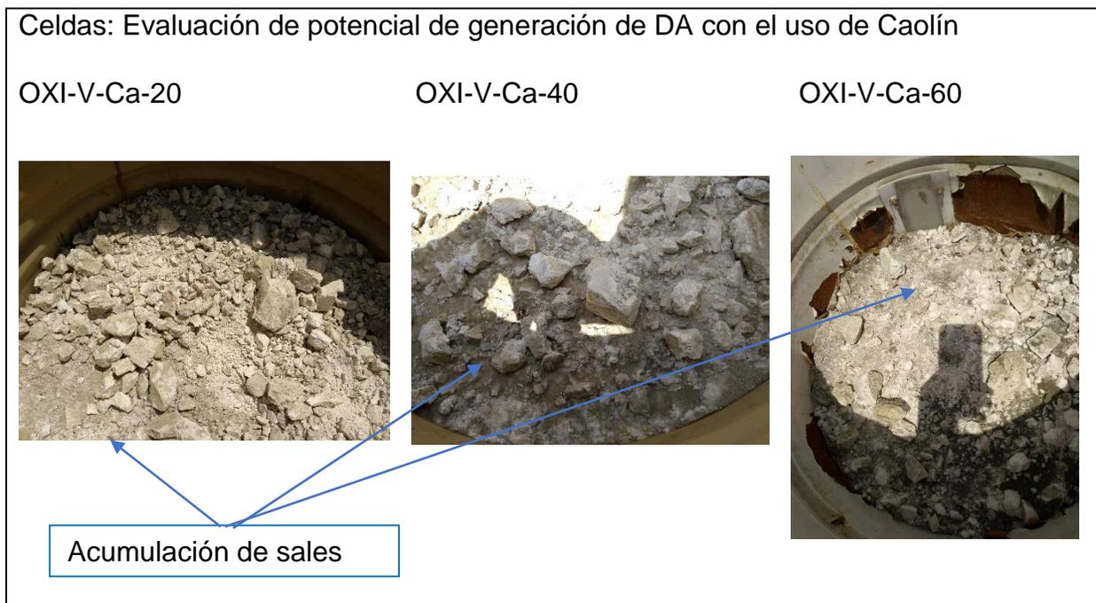
Figura 36 Registro fotográfico de la superficie de la capa de Caolín en las celdas empleadas para evaluar oxidación. A) 20 cm de espesor, B) 40 cm de espesor y C) 60 cm de espesor.
