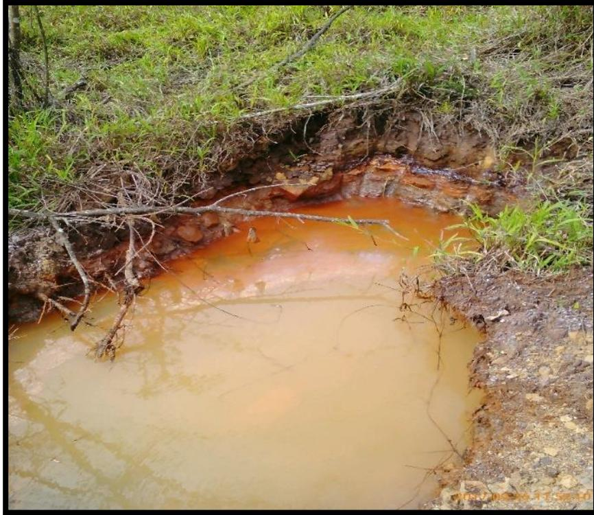
Figura 9 Fotografía de DAM formado en el Talud Este recubierto, de una presa de jales.
