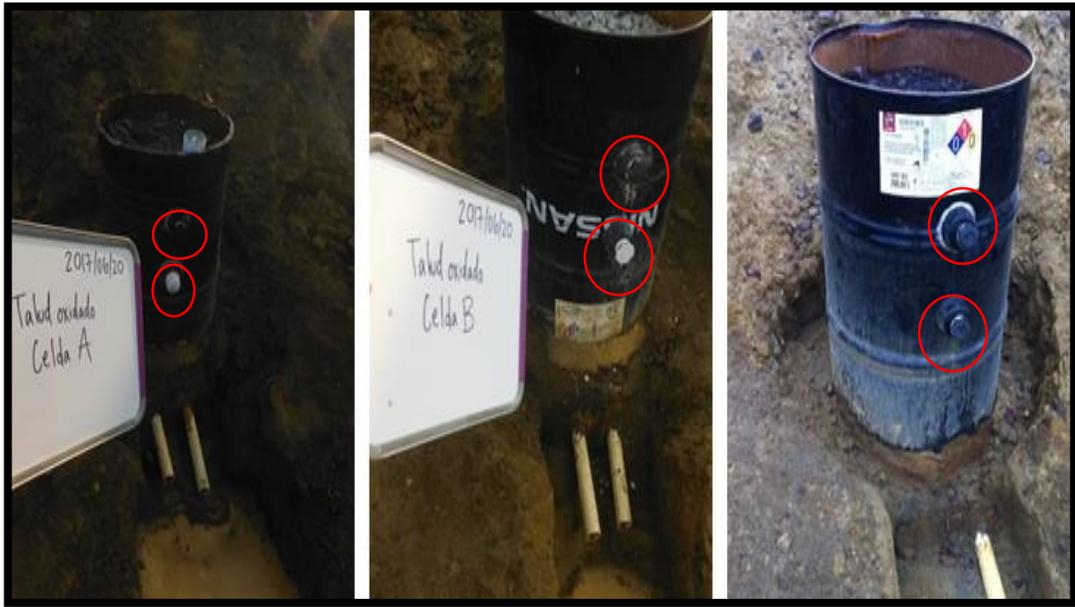
Figura 24 Celdas para evaluar la migración de sales en el Talud Oxidado.
