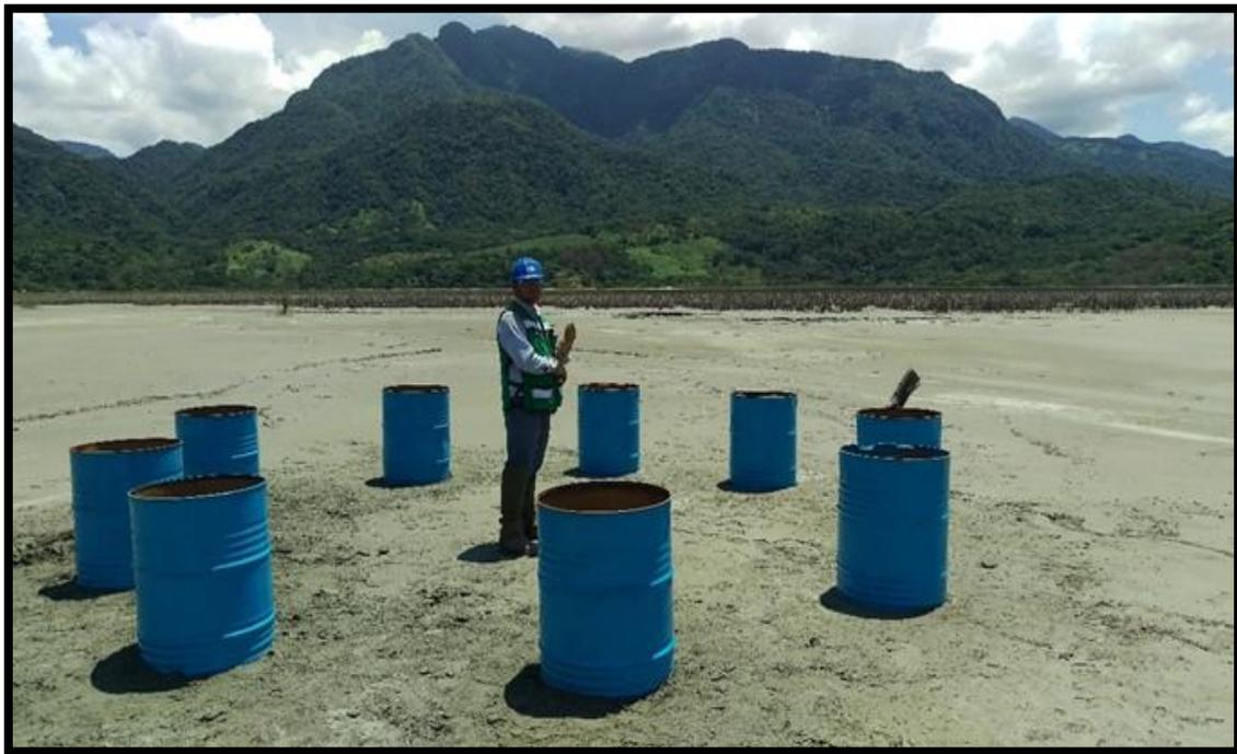
Figura 23 Celdas para evaluar la migración de sales de jal gris en el Vaso de la presa de jales “Guásimas”.
