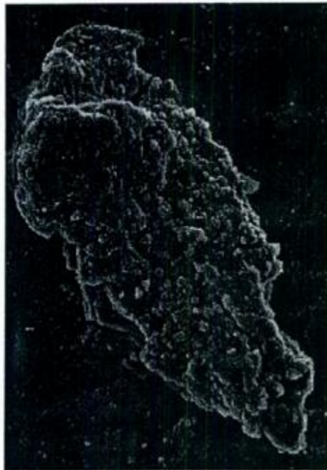
Figura 3.14. Morfología característica de una partícula obtenida por el proceso de atomización por agua. [13]
