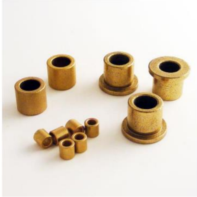
Figura 3.31. Casquillos de bronce autolubricados: Se sinterizan con una porosidad controlada y posteriormente se impregnan con lubricante [31]
