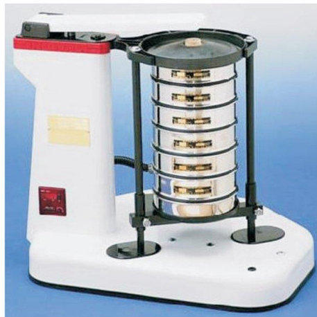
Figura 3.19. Equipo de tamizado por agitación mecánica Ro-Tap. [21]
