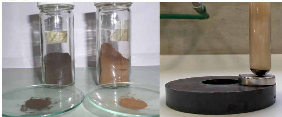
Figura 4.1. a) Magnetita; b)  $\text{Fe}_3\text{O}_4/\text{NTH}$  y c)  $\text{Fe}_3\text{O}_4/\text{NTH}$  en suspensión con campo magnético.
