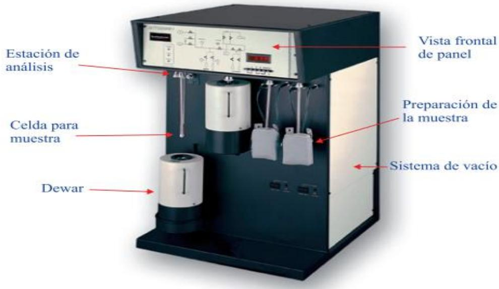
Figura 2.19. Equipo Autosorb-1 C (cortesía de Quantacrome Instruments).
