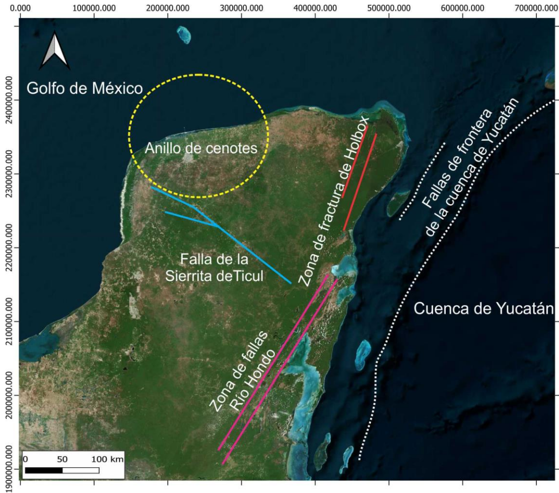
Figura 3. Principales estructuras tectónicas en la Península de Yucatán. Adaptada de Rosencrantz, (1990) y Monroy-Ríos (2020).
