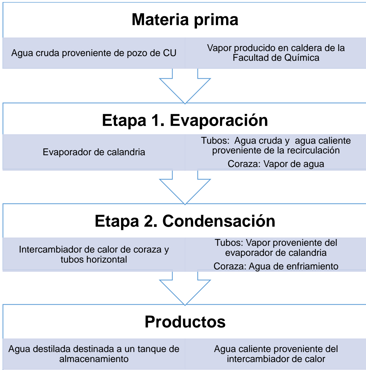
Figura 17. Diagrama de la filosofía de operación para la producción de agua destilada.
