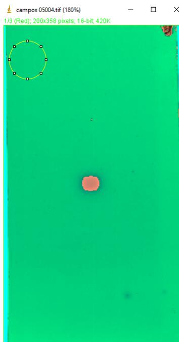
Figura 3.13: Región de interés utilizada para obtener el valor de  $I_{unexp}$  utilizando la película irradiada con un campo de  $0.5\text{ cm} \times 0.5\text{ cm}$ , al centro se observa la región irradiada. Regiones como esta se obtuvieron en las 4 esquinas de la película.
