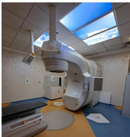
Figura 3.6: Acelerador lineal de electrones (linac) utilizado para las irradiaciones de este trabajo, propiedad del INNMVS. Se observa en la esquina inferior izquierda la mesa de tratamiento y en la región central el Gantry del equipo.
