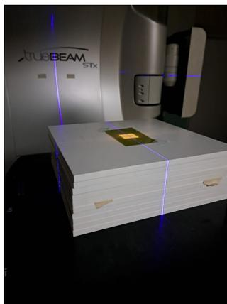
Figura 3.11: Alineación de las películas radiocrómicas con el campo de luz del linac. Se observa que los bordes del campo se encuentran aproximadamente equidistantes al borde de la película y con un margen suficiente para obtener la penumbra del perfil.
