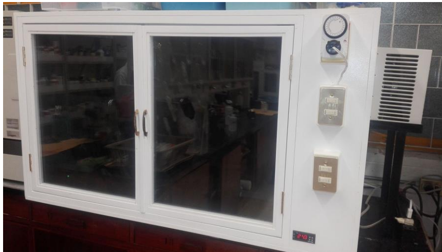
Figura 6. Cámara diseñada para mantener a los cultivos de E. gracilis . Temperatura 20 a 25 \pm 1 °C. Lámparas de luz LED blanca 6,500 K. Fotoperíodo de 12 h luz y 12 h oscuridad. Densidad de fotones fotosintéticamente activos de 80 \pm 5 \mu\text{mol m}^{-2} \text{s}^{-1} . Temporizador y regulador de temperatura automático incorporados. Una malla sombra cubre el interior de los vidrios.
