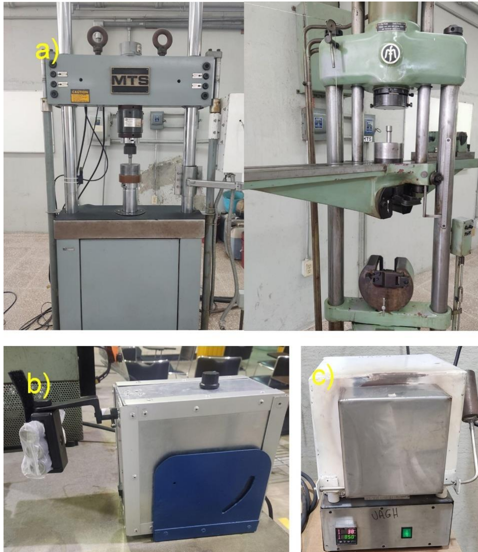
Figura 15. Equipo para pulvimetalurgia a) Maquina universal b) Mezcladora c) Mufia
