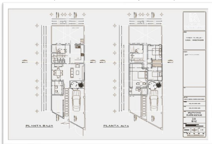
Imagen 53. Proyecto arquitectónico retomando parte de la planta baja que ya estaba construida Autoría propia (2020)
