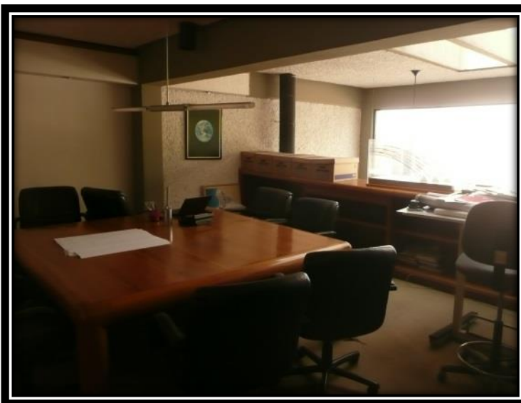
Imagen 269. La sala de juntas contaba con muebles muy pesados como archiveros y una mesa de madera maciza, lo que provocaba un peso excesivo para la estructura de madera del entresuelo, ya que presentaba un hundimiento de aproximadamente de 15 a 20 centímetros. Autoría propia (2012)
