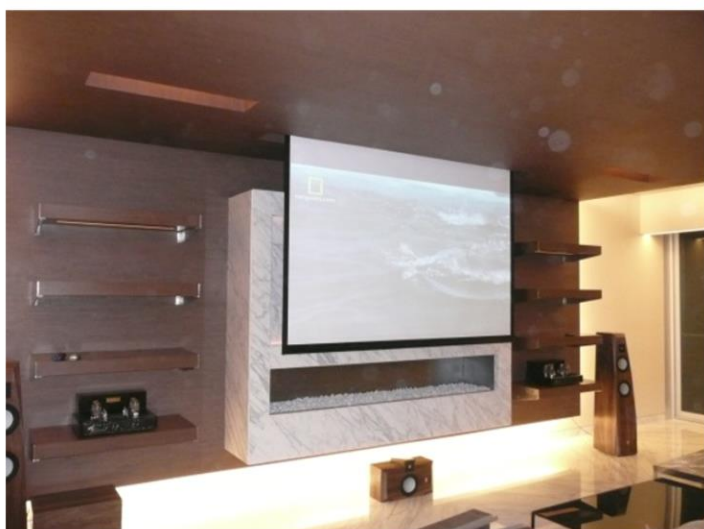
Imagen 215. Instalación de pantalla retráctil enrollable de alta definición, que baja del plafón de madera vía remota Autoría propia (2011)
