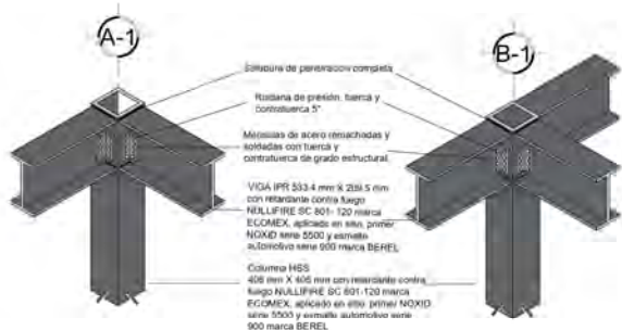
ISOMETRICOS UNIÓN DE VIGAS CON COLUMNA ESCALA: 1:15
