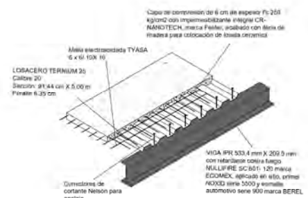
DETALLE DE ANCLAJE DE LOSACERO ESCALA: 1:15
