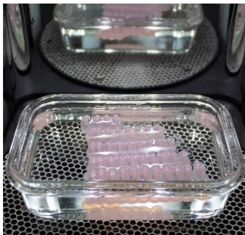
Fotografía 4. Post-polimerización de las muestras en Form Cure.
