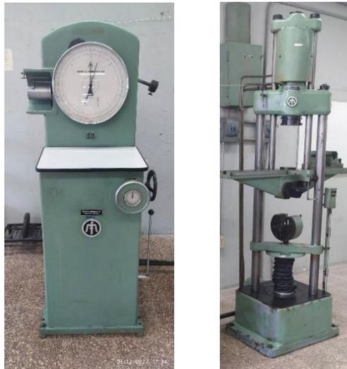
Figura 19. Máquina de ensayos universal, marca "Mohr & Federhaff Losenhausen".
