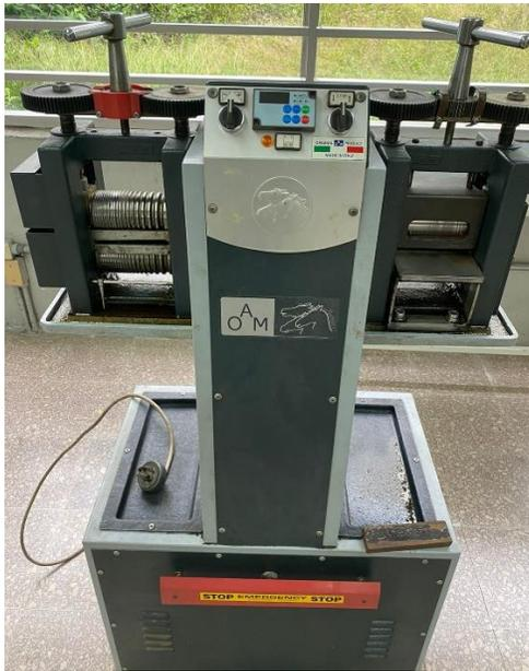
Figura 22. Máquina laminadora, marca "OAM CAVALLIN M120".
