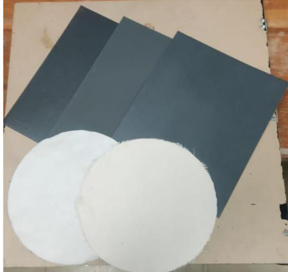
Figura 17. Material utilizado para la preparación metalográfica de las muestras previamente montadas en frío.
