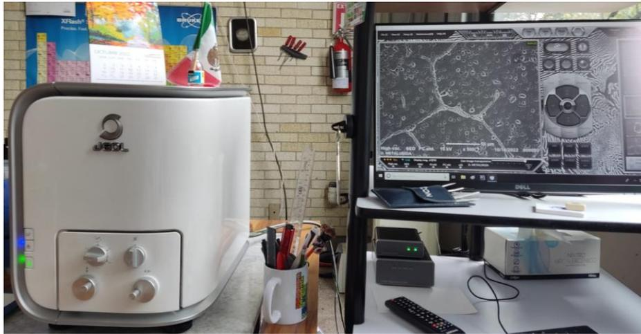
Figura 21. Microscopio electrónico de barrido, marca “JEOL JCM-6000 NeoScope”.
