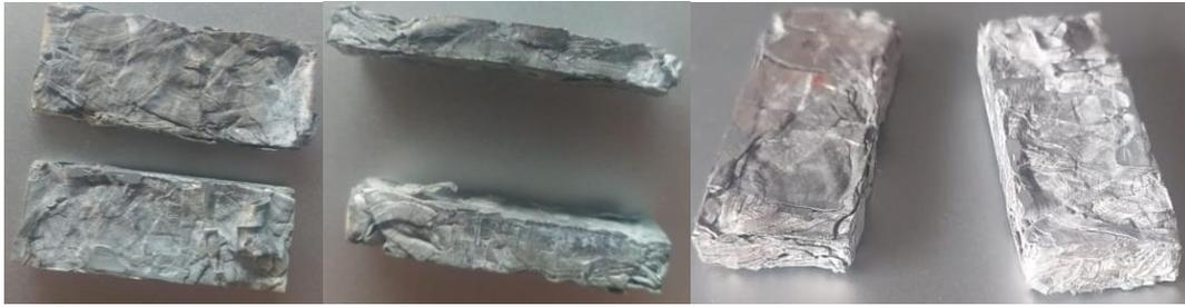
Figura 38. Diferentes perspectivas de las probetas realizadas con viruta de aluminio.
