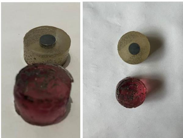
Figura 16. Ejemplo de muestras de residuos limpios montadas en frío.
