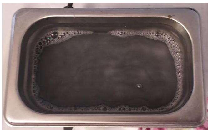
Figura 12. Limpieza de muestras de rebaba con una mezcla de sales de potasio de ácidos grasos.
