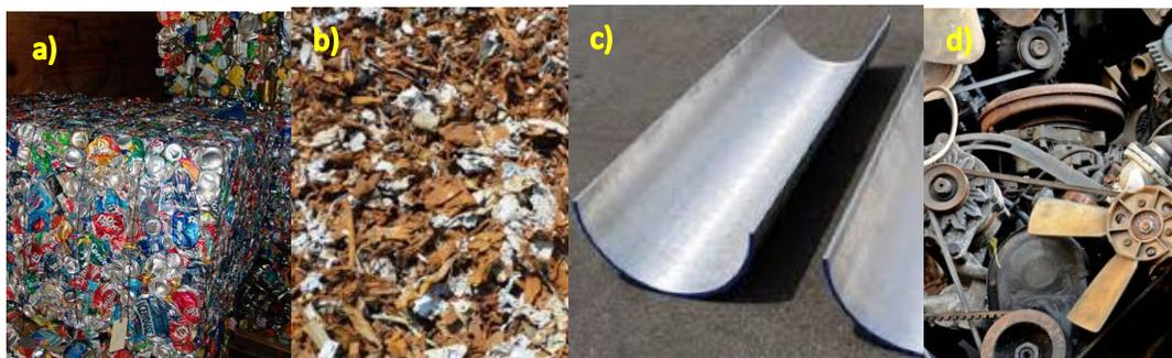
Figura 1. Tipos de impurezas intrínsecas; a) pintura, b) óxido, c) revestimientos y d) suciedad superficial [9].
