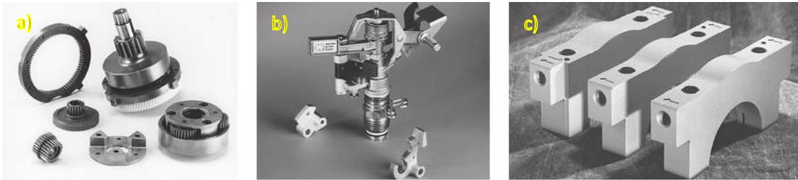
Figura 3. (a) Ejemplos de partes comunes fabricadas por medio de procesos de metalurgia de polvos. (b) Palanca superior de disparo para un rociador comercial de riego elaborada mediante M/P. Esta parte se produce con una aleación de latón sin plomo; reemplaza a una parte fundida a presión en matriz con un ahorro de 60% del costo. (c) Tapas fabricadas por metalurgia de polvos para soportes principales para motores automovilísticos (cojinetes) de 3.8 y 3.1 litros de General Motors [19].
