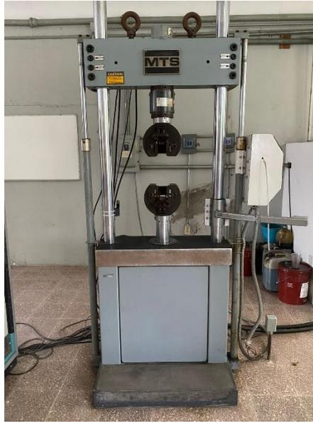
Figura 20. Máquina de ensayos universal, marca “MTS”.
