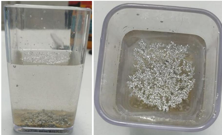
Figura 24. Separación de rebaba de Al y madera mediante métodos gravimétricos, se puede apreciar una clara aglomeración en el fondo del vaso.
