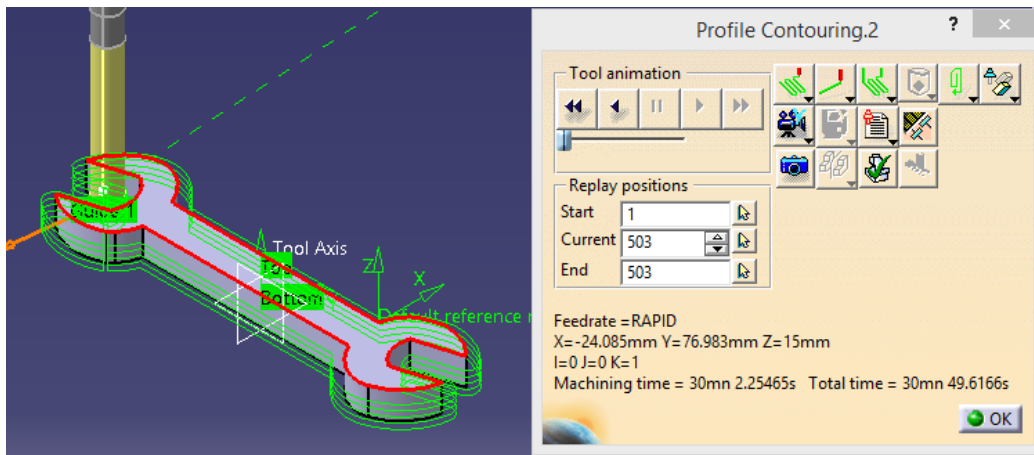
Figura 3.32 Trayectorias obtenidas a partir de los parámetros propuestos.
