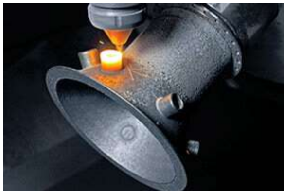
Figura 1.7 Pieza fabricada por DED (cortesía de ALL3DP).
