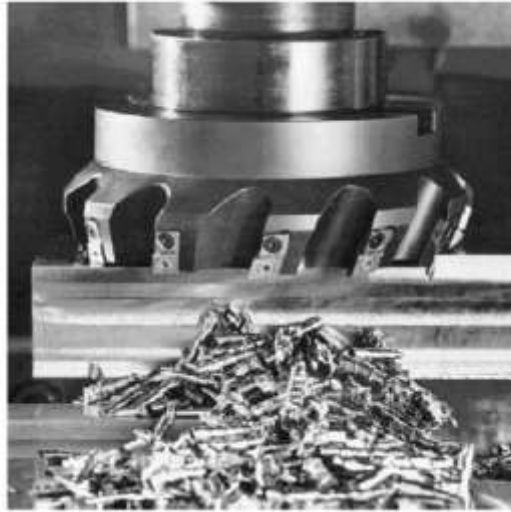
Figura 1.13 Cortador de fresado de careado con insertos indexables. Fuente: Cortesía de Ingersoll Cutting Tool Company
