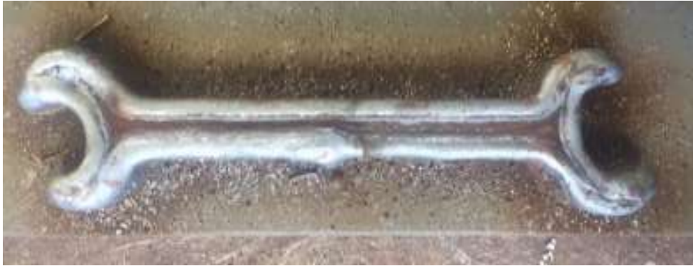
Figura 4.2 Manufactura aditiva del diseño de la llave de Prueba 2.
