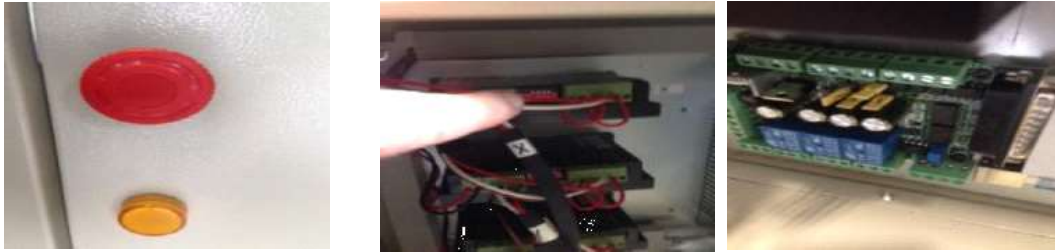
Figura 2.3 Driver independiente, tarjeta de control y switch de encendido y apagado.
