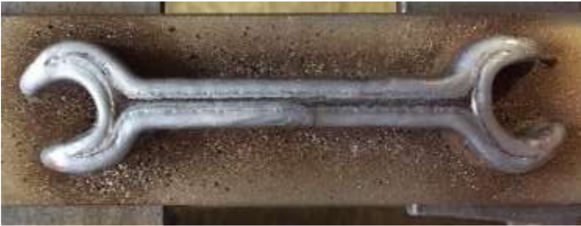
Figura 4.4 Manufactura aditiva de llave de Prueba 3.
