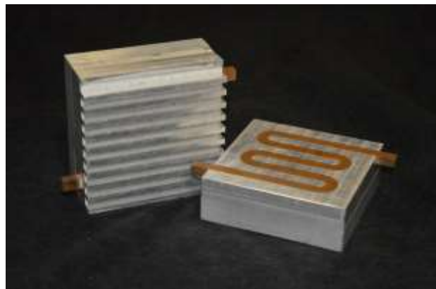
Figura 1.5 Pieza obtenida con proceso LOM.
