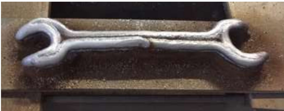
Figura 4.5 Manufactura aditiva de llave de Prueba 3.
