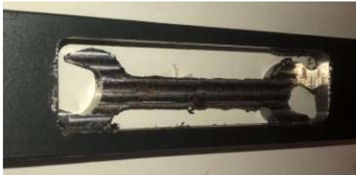
Figura 4.8 Acabado en la parte inferior de la llave.
