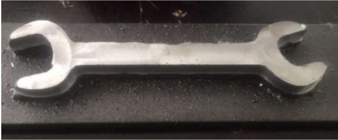
Figura 4.7 Acabado en la parte lateral de la llave.
