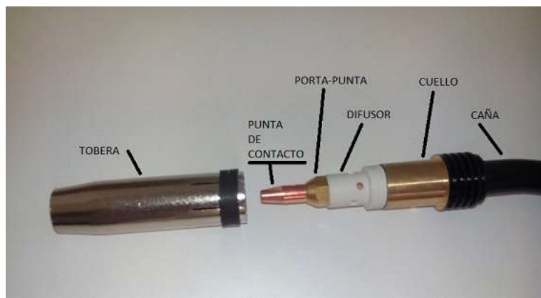
Figura 1.24 Tobera y boquillas del proceso MIG.
