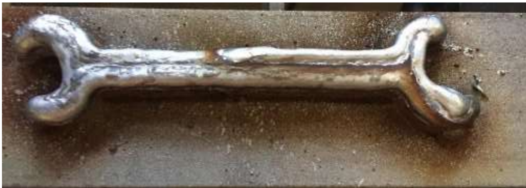
Figura 4.1 Manufactura aditiva del diseño de la llave de Prueba 1, incompleta en su extremo derecho.
