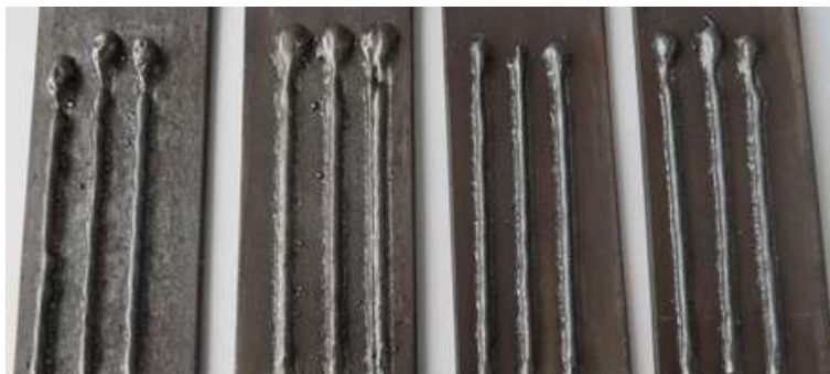
Figura 2.7 Muestra de algunas pruebas preliminares para determinar parámetros en el proceso MA.
