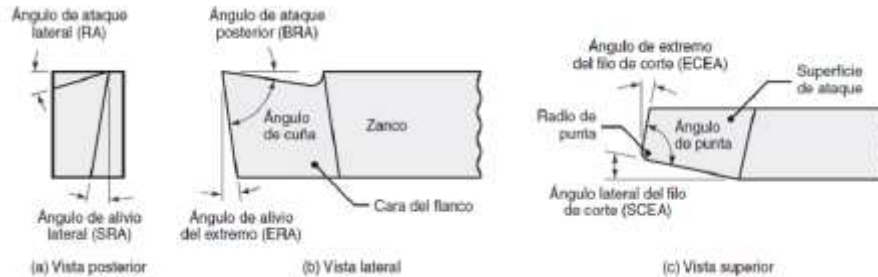
Figura 1.9. Designaciones de herramienta de corte derecho. El termino derecho se refiere al avance de corte de las herramientas de derecha a izquierda.
