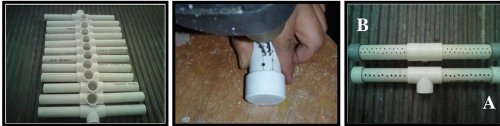
**Figura A3-3. Construcción de difusores y colectores.**
