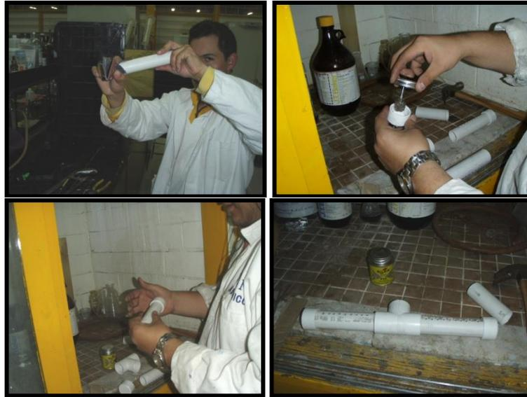
Figura A3-4. Armado y pegado de las flautas de alimentación y captación.
